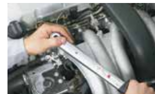
Устанавливайте и снимайте свечи накаливания ТОЛЬКО с помощью динамометрического ключа.
