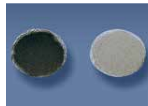
Частицы сажи откладываются на фильтрующем элементе в течение трех минут после холодного пуска. С последующим нагревом (справа) частиц сажи прим. на 40 % меньше, чем при использовании технологии с поддержанием нагрева после запуска.
