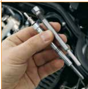
Развертка колодца свечи накаливания BERU - (RA003 - 0 890 100 003) очищает коксовые отложения со стенок свечного колодца.
