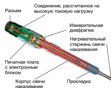
«Умная» свеча PSG (свеча накаливания с датчиком давления).
